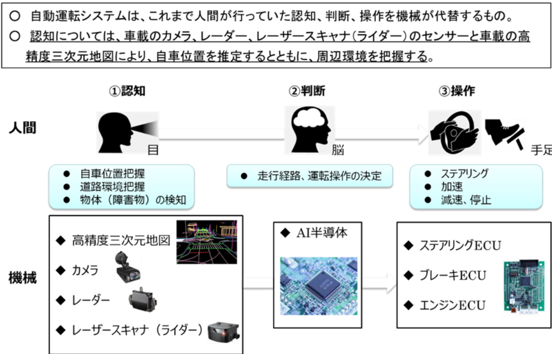
(図) 自動運行装置（自動運転システム）の概要
